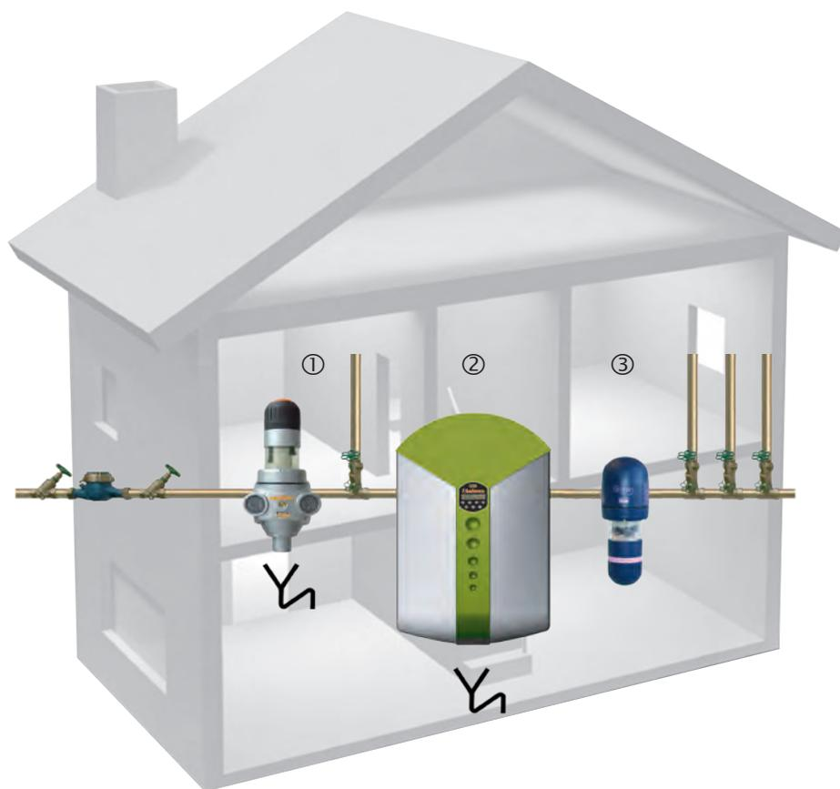
Die nebenstehende Abbildung zeigt den Einbau der Geräte in der Reihenfolge nach dem Wasserzähler:
